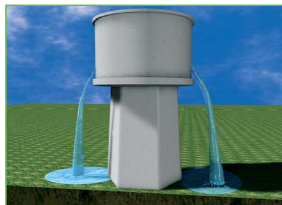
Täysinäisiin vesisäiliöihin ei pääse asentamaan vedeneristyskerrosta sisäpuolelta. Ulkopuolelta tehtävä vedeneristys (negatiivisen puolen vedeneristys) on välttämätöntä jotta vesisäiliön toiminta ei keskeytyisi.
