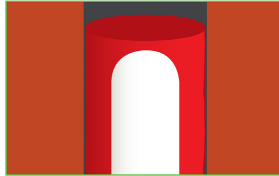
Kapillaarin kaventaminen/sulkeminen, muodostaen elastinen peite kapillaarin sisään
